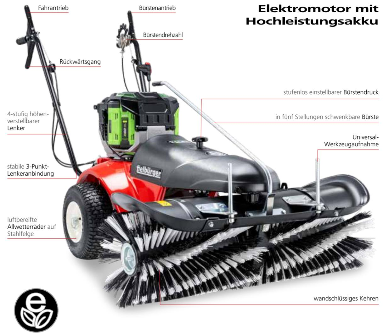
**Elektromotor mit Hochleistungsakku**
