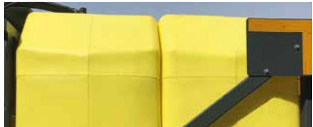
Bei Tanks mit Kaskadenausführung (mehrere Tanks hintereinander) kommt es oft zu undichten Stellen zwischen den einzelnen Tanks.
