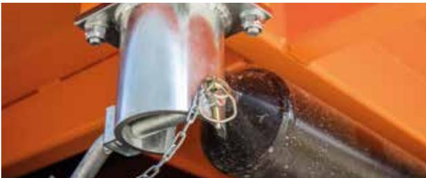
Der Multiwash-Pritschenaufbau lässt sich sicher über Kugelpunkte oder direkt über die Pritsche mit dem Trägerfahrzeug verbinden.
