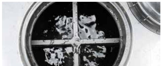
Das Innenleben eines ecotech Multiwash-Pritschenaufbau-Wassertanks. Die Schwallwände teilen den Tank in Kammern.
