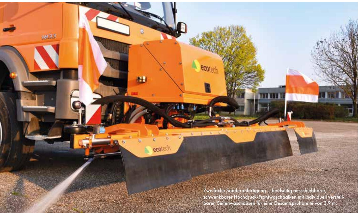
Zweifache Sonderanfertigung – beidseitig ausschiebbarer, schwenkbarer Hochdruck-Frontwaschbalken mit individuell verstellbaren Seitenwaschdüsen für eine Gesamtsprühbreite von 3,9 m.
