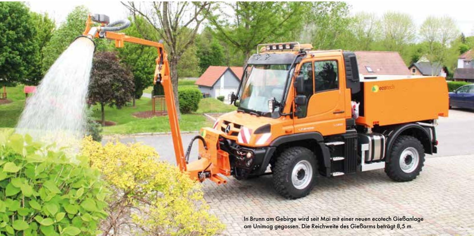
In Brunn am Gebirge wird seit Mai mit einer neuen ecotech Gießanlage am Unimog gegossen. Die Reichweite des Gießarms beträgt 8,5 m.
