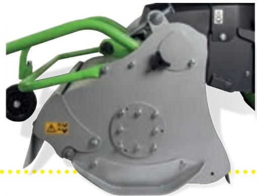
Schnitthöhe über zwei Vorderräder einstellbar (20 bis 90 mm)
